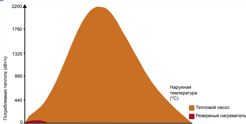
Рисунок 6. Соотношение тепла, поставляемого тепловым насосом и производимого резервным нагревателем
